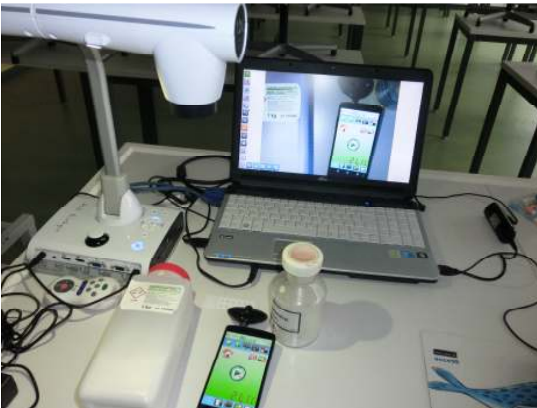
Projektionstechniken: Flexkamera und Fernseher (hinten) sowie Laptop-Beamer Kombination, Webkamera vorne Mitte) und digitale Mikroskopkamera (vorne rechts)
